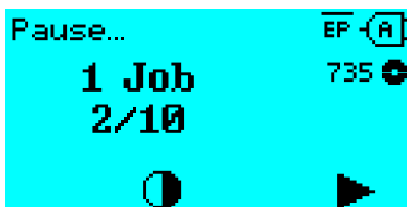
Bild 52: Gestoppter Druckauftrag. Taste 4 drücken, um fortzufahren.
