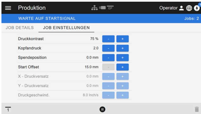
Bild 21: Ansicht „Job Einstellungen“ eines Druckauftrags im Webpanel. Mit der aktiven Rolle (hier: „Operator“) nicht zugängliche Einstellungen sind ausgegraut. Die anderen Einstellungen können durch klicken auf „+“ oder „-“ verändert werden.
