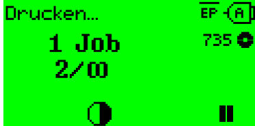
Bild 51: Druckauftrag mit endloser Druckmenge.
