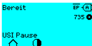
Bild 56: Beispiel: USI-Statusmeldung „USI Pause“.
