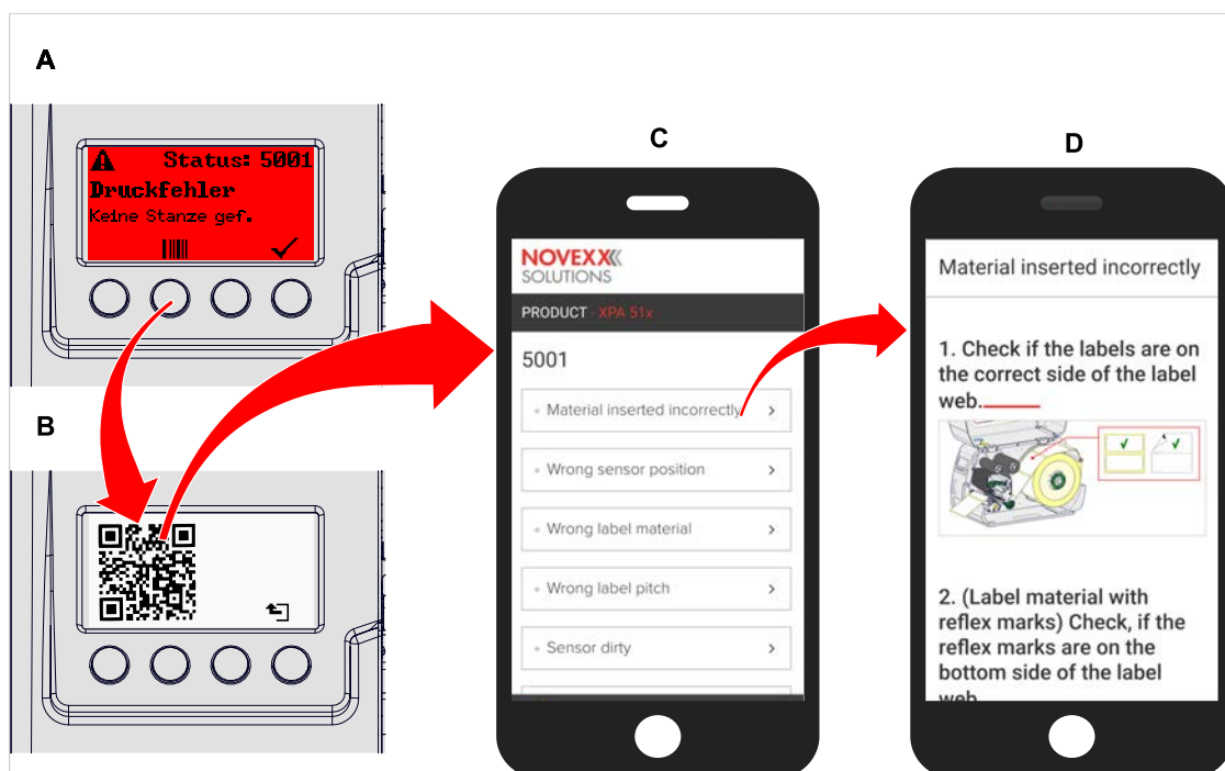
Bild 57: Wenn die Fehlermeldung ein Barcode-Symbol aufweist (A), kann über einen QR-Code (B) eine Anleitung zur Fehlerbehebung (C) auf dem Smartphone aufgerufen werden.
