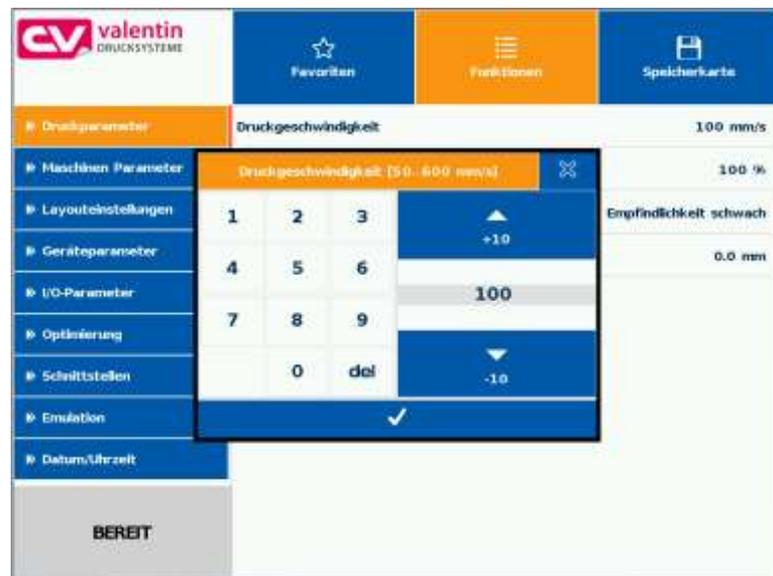
In der Kopfzeile des Eingabedialogs werden der Name des Parameters und der zulässige Wertebereich angezeigt. Die Eingabe wird auf Gültigkeit geprüft. Ist der eingegebene Wert nicht zulässig, ist
