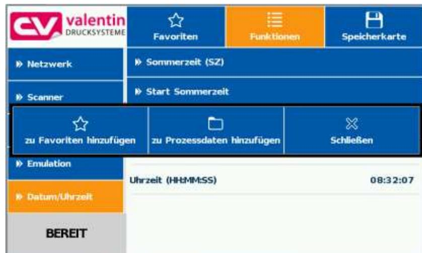
Durch langes Drücken (2 s) auf einen Parameter (z.B. aktuelle Uhrzeit) wird die zugehörige Auswahl angezeigt.
