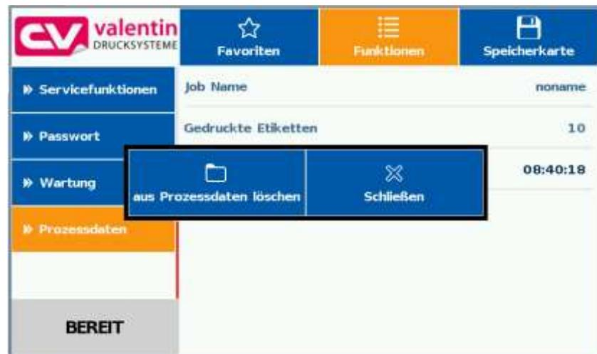
Durch langes Drücken (2 s) auf einen Parameter (z.B. aktuelle Uhrzeit) wird die zugehörige Auswahl angezeigt. Mit *aus Prozessdaten entfernen* wird der ausgewählte Parameter von der Liste entfernt.
